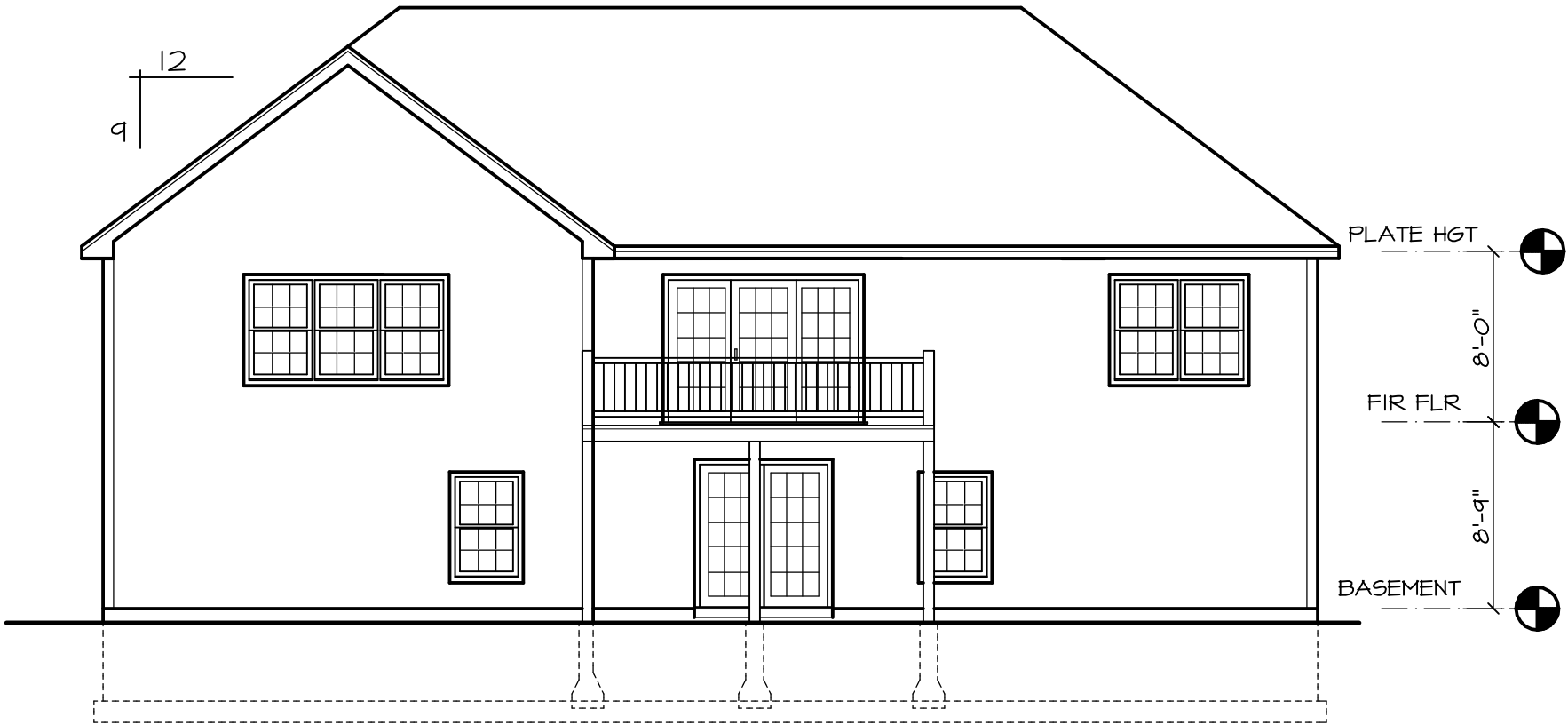
1 REAR ELEVATION A3 SCALE: 1/8" = 1'-0"
